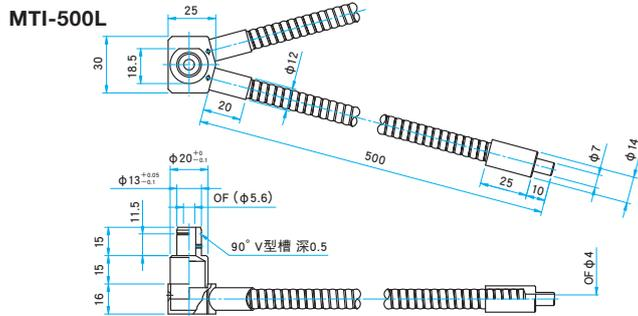
外侧为套管型以及不锈钢半刚性型的导光部，由于其柔性结构，适用于狭小空间并且可以随意弯曲。
